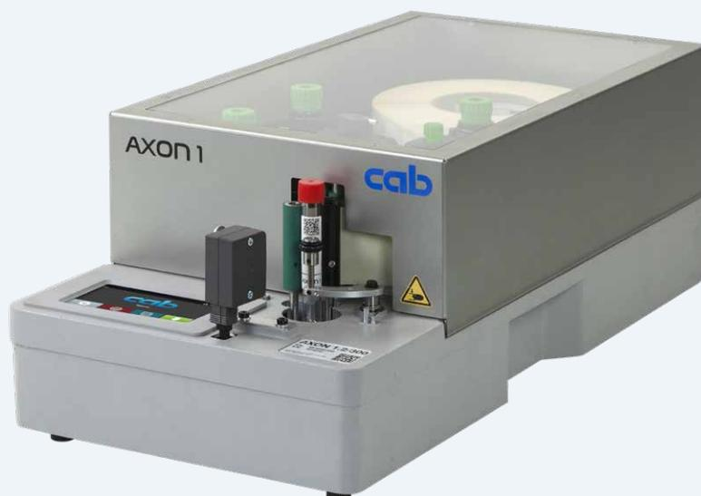
**AXON 1** per la marcatura sicura di provette e fiale
